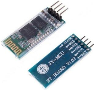
4.2.2. Bluetooth HC-05, ayuda a comunicarse con el módulo exterior y de esta forma poder almacenar los datos que se obtienen de los sensores.
