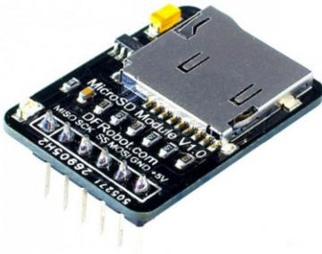
4.2.3. Tiene un módulo para identificar la tarjeta micro sd en donde se tendrá un registro de los datos adquiridos con los sensores junto con la hora y fecha de la medición.
