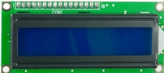
4.2.4. Una pantalla LCD 16X2, que muestra la información de fecha, hora, temperatura, humedad e índice UV que serán almacenados.
