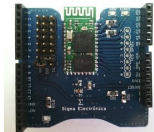
4.1.2.3. Circuito impreso en fibra de vidrio que tiene las conexiones de alimentación para todos los elementos.
