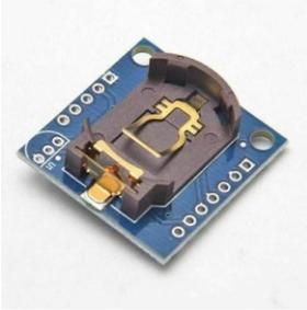
4.2.1. Reloj en tiempo real, que mantiene la hora y fecha actual para que pueda ser registrado cada dato de medición con esta información y a la vez se muestre la hora en el panel.
