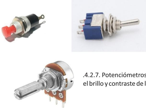
4.2.6. Pulsador e interruptores, que reinician el programa y controlan el ON/OFF del reloj y el módulo de microsd, respectivamente.
