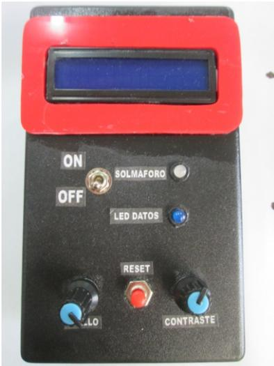
5.1 Este pequeño instrumento portátil en la caja negra muestra el nivel de radiación UV por medio de una pantalla LCD y un LED que indica el correspondiente color con el nivel medido, además tiene perillas para ajustar el brillo y contraste de la pantalla LCD, un botón de reset, un LED que indica el momento en el que el sensor UV, que se encuentra en la parte superior de la caja, está tomando datos y por último un interruptor para apagar el instrumento y poderlo cargar.
