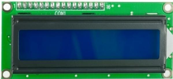
5.1.2. Pantalla LCD 16X2, muestra los datos obtenidos del sensor UV del portátil.
